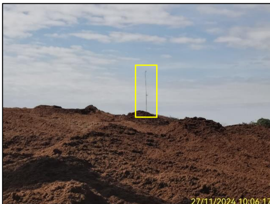
ภาพที่ 2.2-60 มาตรวัดระดับความสูงลาน กองกากอ้อย
