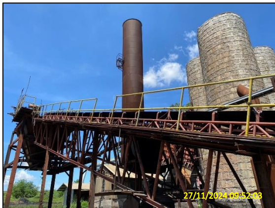
ภาพที่ 2.2-14 ระบบสายพานลำเลียงขี้เถ้า
